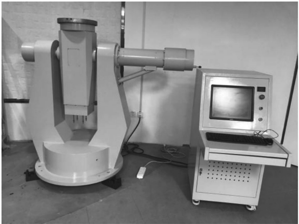
图6 高精度双轴转台
