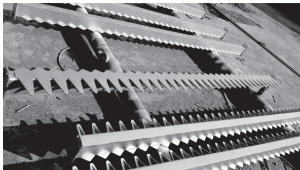
图 3 矩形管板式耙齿
