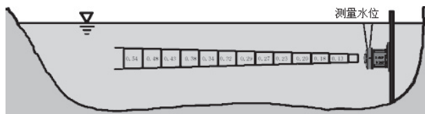
图 1 水平声学多普勒流速法工作示意图
