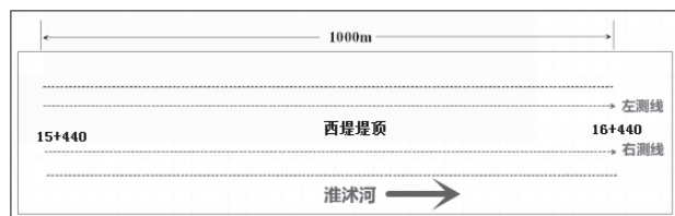
图1 试验段堤防物探测线布置示意图
