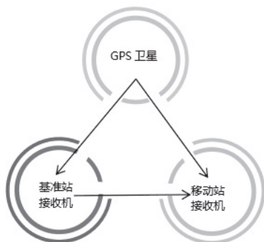
图1 GPS-RTK 工作原理图
