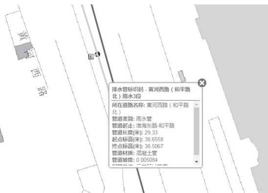
图2 排水管网信息系统数据查询界面
