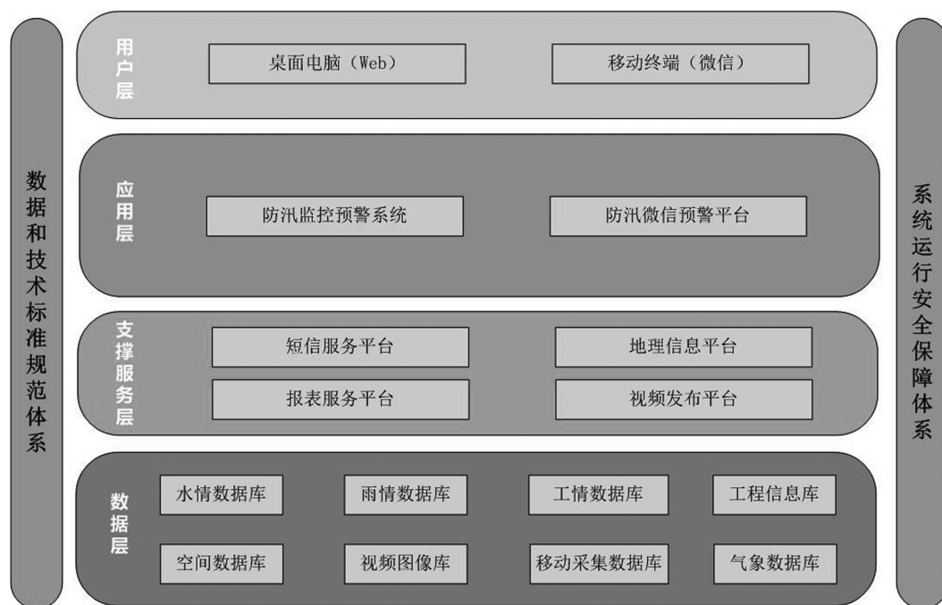
图 2 防汛监控预警一体化平台总体架构图
