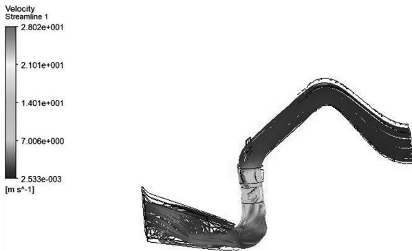
图3 水泵变频反向发电时的流线图
