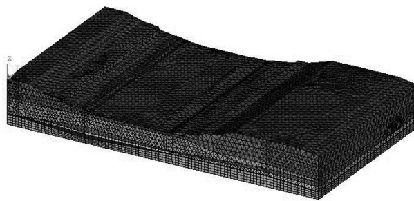
图2 秦淮新河地铁下穿段三维地质模型
