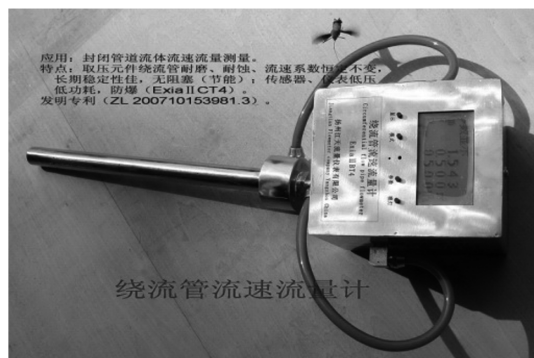
图4 绕流管流量计
