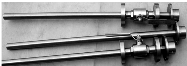
图8 带截止阀大泵绕流管流量计
