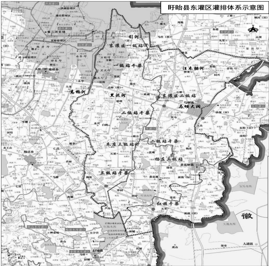
图 1 盱眙县东灌区灌排体系示意图
