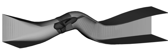
图 2 斜式轴伸泵装置
