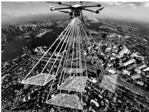
图 1 倾斜摄影测量原理
