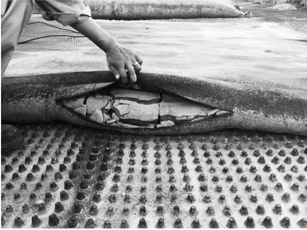
图 4 脱水 30d 后的干裂淤泥
