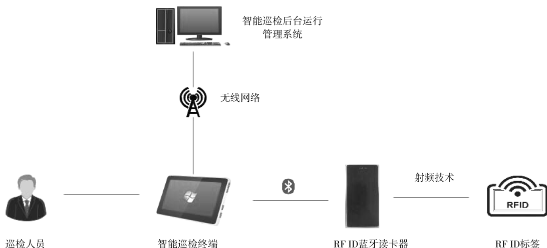
图2 通吕运河水利枢纽工程巡检系统基本原理
