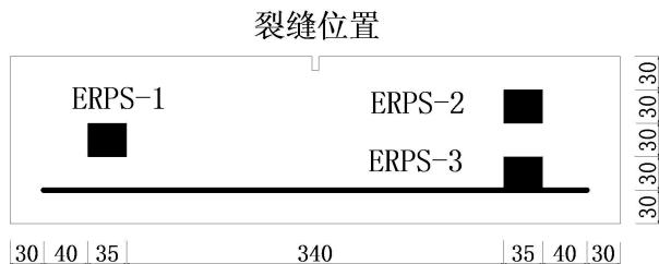
图4 混凝土梁开裂损伤辨识试验梁切缝位置(单位:mm)
