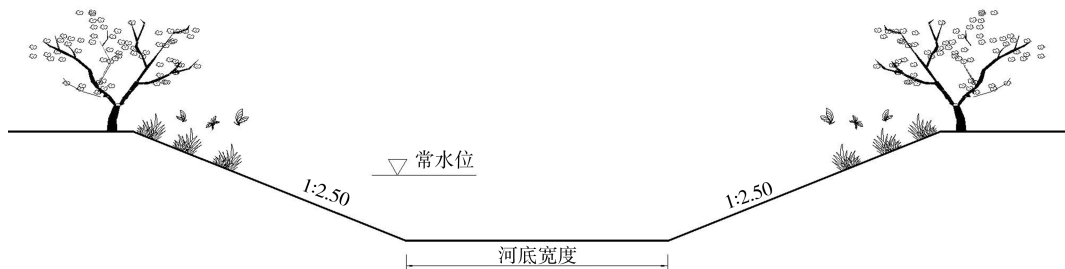
图4 渠西河绿化植被典型设计
