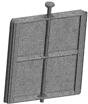
图 2 立轴旋转钢闸门的结构网格
