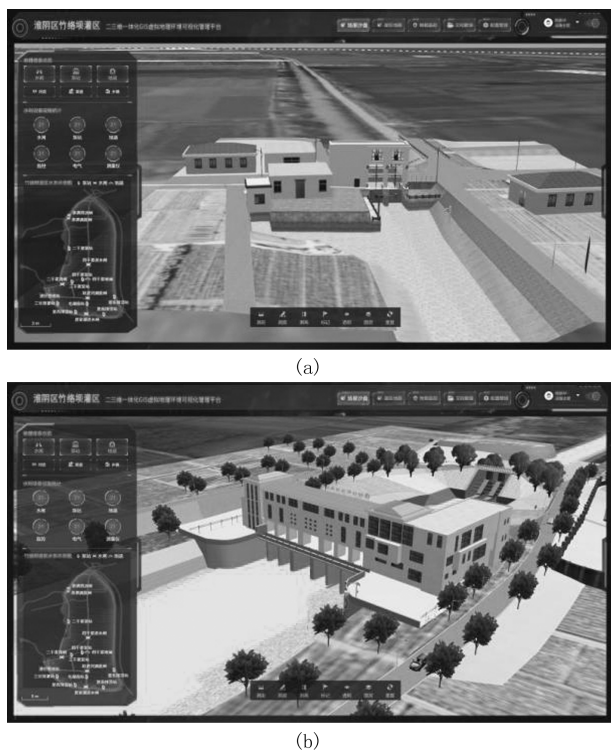
图 7 基于 3D GIS + BIM 技术的灌区水利设施 3D 建模效果图
