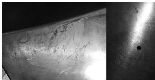
图2 泵站叶轮损伤图
