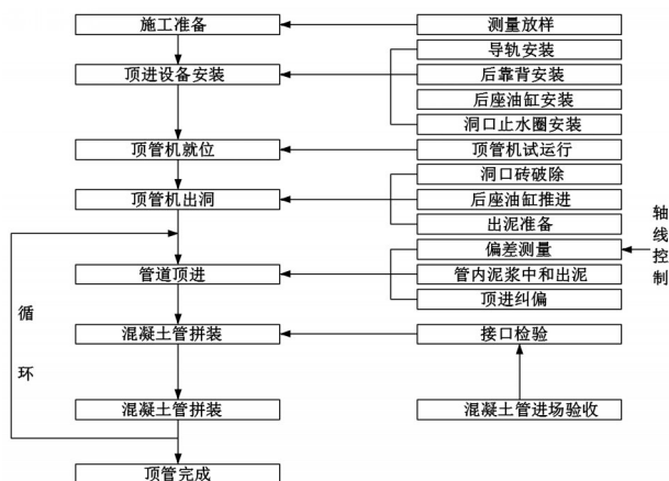
图1 顶管工程施工流程
