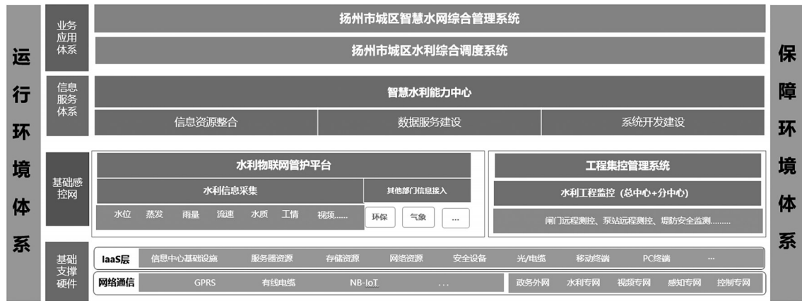
图1 扬州市城区智慧水网建设试点项目总体架构
