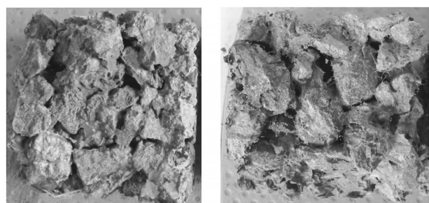
图6 生态混凝土试件劈拉破坏形态
