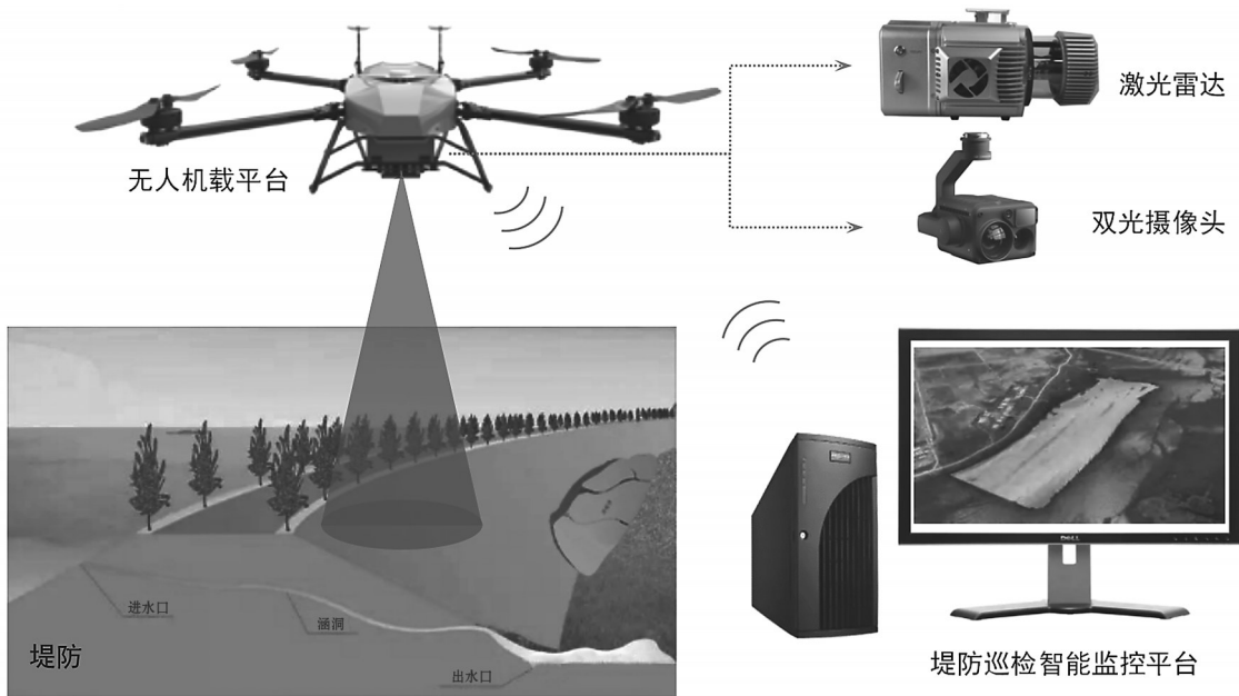
图1 基于激光雷达、可见光及热红外传感设备的空中巡堤平台
