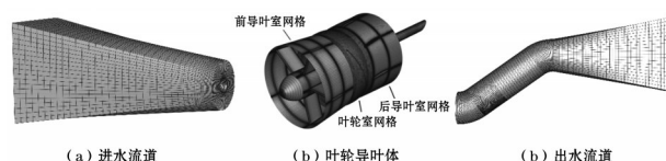
图2 各过流部件网格示意
