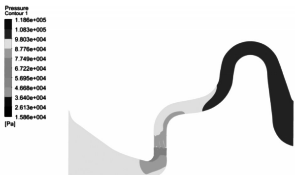
图7 泵站流道中截面压力云图
