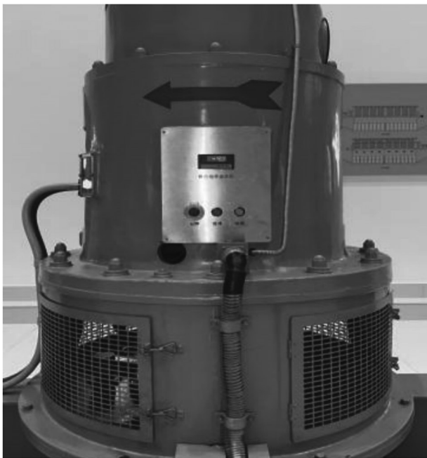
图4 数字显示装置安装位置
