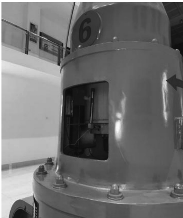
图3 位移传感器安装位置
