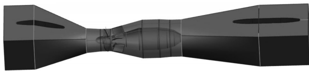
图2 灯泡贯流泵装置示意
