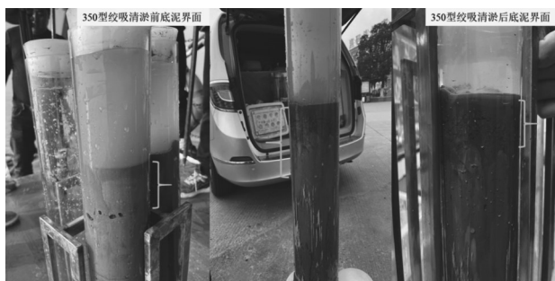
图5 绞吸式(350型)清淤前后底泥界面观察
