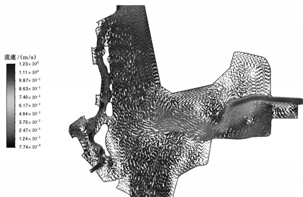
图5 全疏导布置浅滩湿地段水流结构
