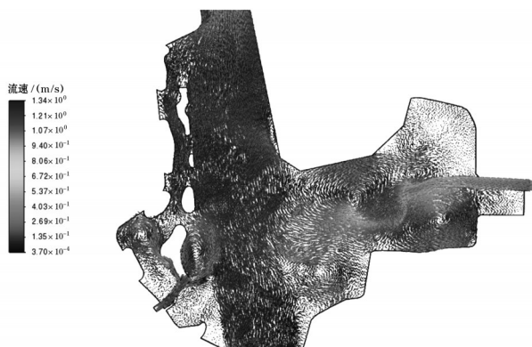
图4 半疏导布置浅滩湿地段水流结构
