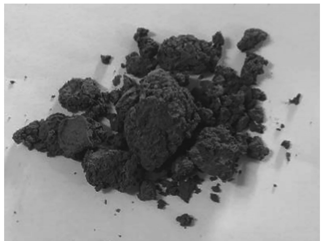
图1 试验用膨胀土
