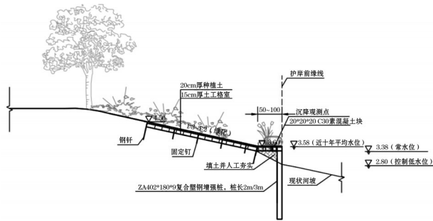
图1 A1型护岸结构(单位:cm)
