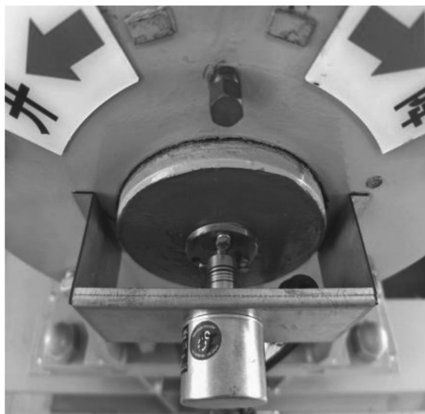
图2 编码器安装示意
